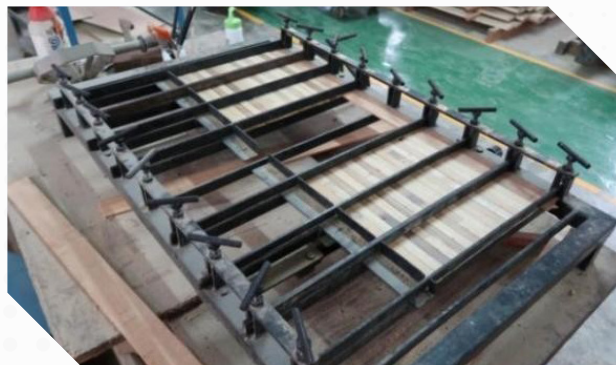
Proses penyediaan papan laminasi Buluh di FRIM, Kepong
