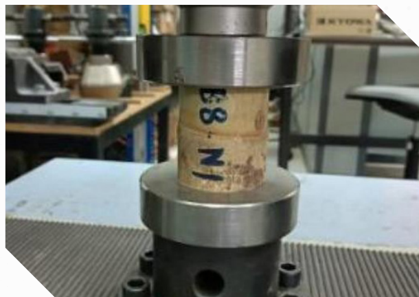
Pengujian tekanan mampatan pada buluh
