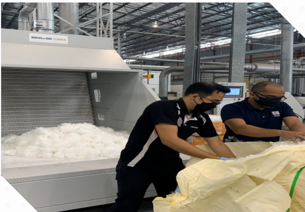
Aktiviti penghasilan non-woven fabrik dari Kenaf/PP mengikut spesifikasi pelanggan
