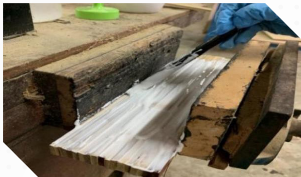
Proses penyediaan papan laminasi Buluh di FRIM, Kepong
