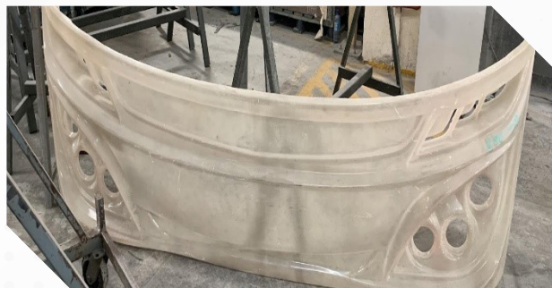
Kerja R&D fabrikasi bahagian bumper bus dari komposit kenaf/PP non-woven di Tan Chong Seri Kembangan
