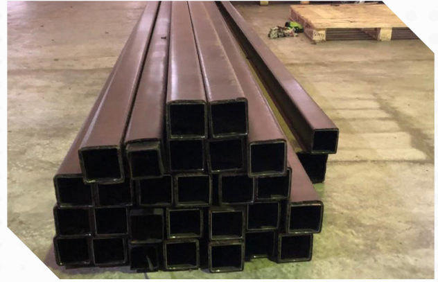
Penghasilan Metal reinforced WPC untuk aplikasi pembinaan ( structural )
