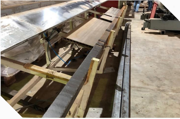
Penghasilan Metal reinforced WPC untuk aplikasi pembinaan ( structural )
