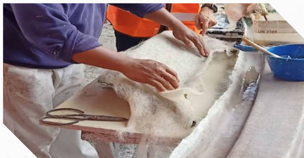
Kerja R&D fabrikasi bahagian bumper bus dari komposit kenaf/PP non-woven di Tan Chong Seri Kembangan
