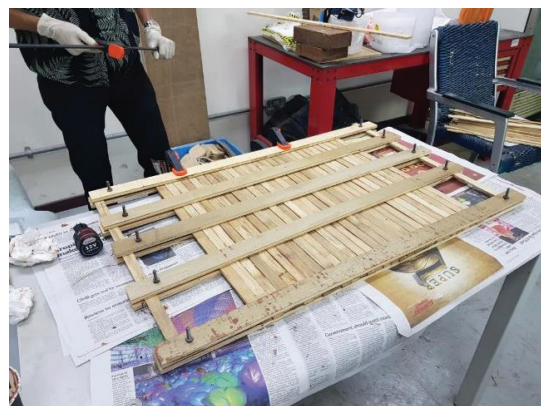
Sumber bahan mentah buluh yang diasingkan mengikut ketebalan dinding, potong kepada bilah dan seterusnya melalui proses damping bagi menghasilkan produk buluh berlapis silang ( Cross Laminated Bamboo ) untuk projek kajian peningkatan kualiti, kapasiti pengeluaran dan recovery rate bagi produk kayu dan biokomposit
