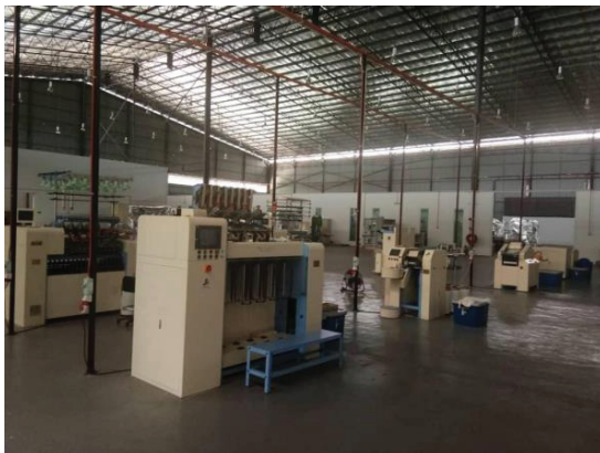
Mesin pemprosesan woven di FIDEC 3 yang disediakan untuk kemudahan industri dan universiti bagi pembuatan tekstil khusus untuk penghasilan produk biokomposit ( Advance Green Composite )
