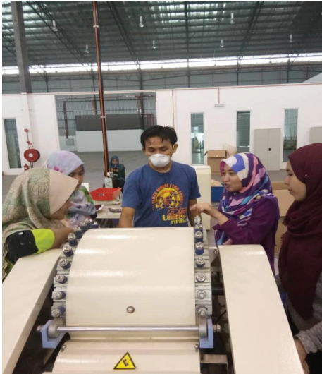
Mesin carding digunakan bagi proses web forming gentian daripada campuran kenaf dan kapas
