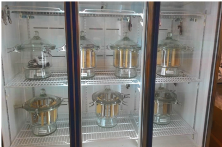
Ujian pembebasan formaldehid terhadap papan lapis yang sedang dijalankan di makmal kimia menggunakan kaedah dessicator , Japan Agricultural Standard (JAS)
