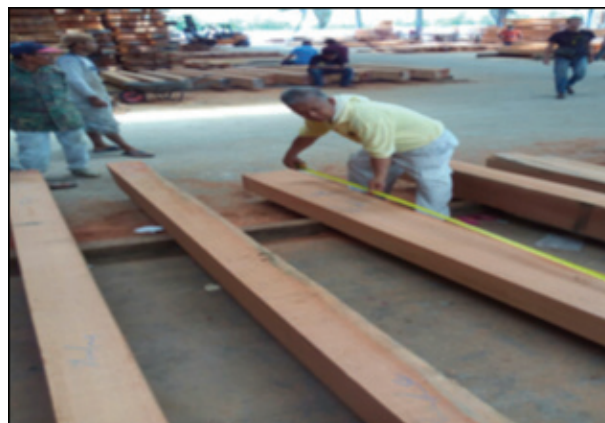
Teknik pengukuran bagi mendapatkan saiz sebenar kepingan kayu
