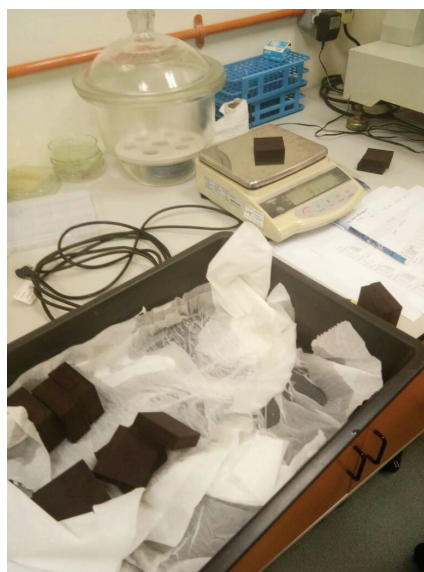
Perkhidmatan pengujian water absorption dan thickness swelling antara perkhidmatan yang disediakan di makmal mekanikal.
