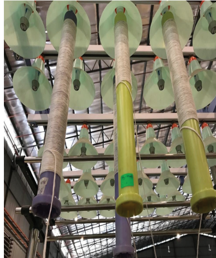
Penghasilan sliver daripada campuran gentian kenaf dan kapas pada mesin roving
