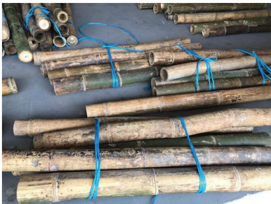
Sumber bahan mentah buluh yang diasingkan mengikut ketebalan dinding, potong kepada bilah dan seterusnya melalui proses damping bagi menghasilkan produk buluh berlapis silang ( Cross Laminated Bamboo ) untuk projek kajian peningkatan kualiti, kapasiti pengeluaran dan recovery rate bagi produk kayu dan biokomposit
